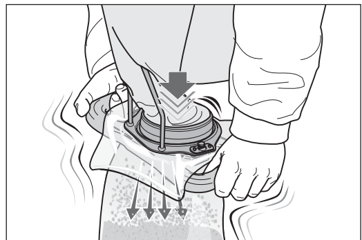
Abb. 23 Den Staubsack durch kräftiges Schütteln entleeren.
